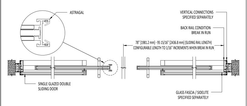
HORIZONTAL SECTION THROUGH OPEN DOUBLE SLIDING DOOR - SINGLE GLAZED FRAMED - BREAK IN RUN
