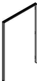
**F W D P D J** Ensemble de jambage pour porte pivotante à deux battants
